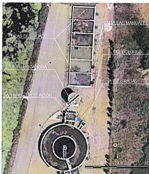
Imagen 14: Montaje de la recirculación. Fuente: Elaboración propia
